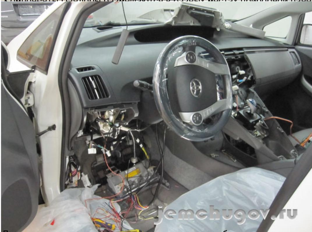
Для установки сигнализации нужно немного разобрать машину
