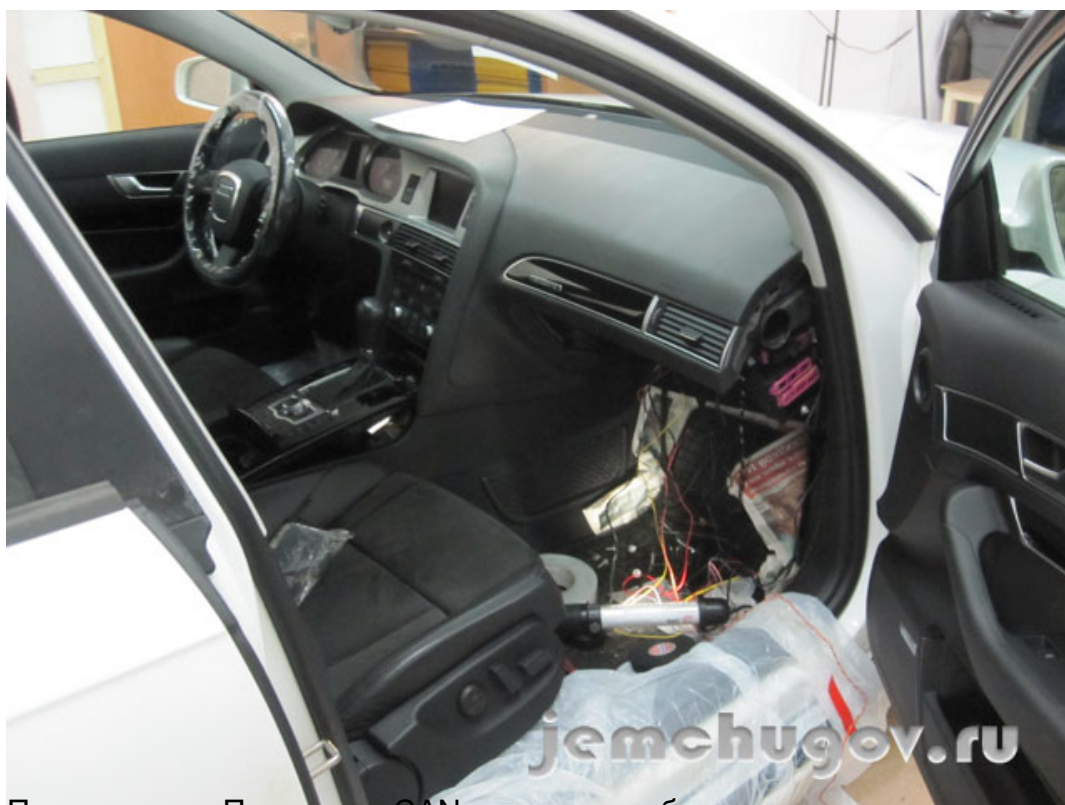
Подключение Pandora к CAN шине автомобиля
