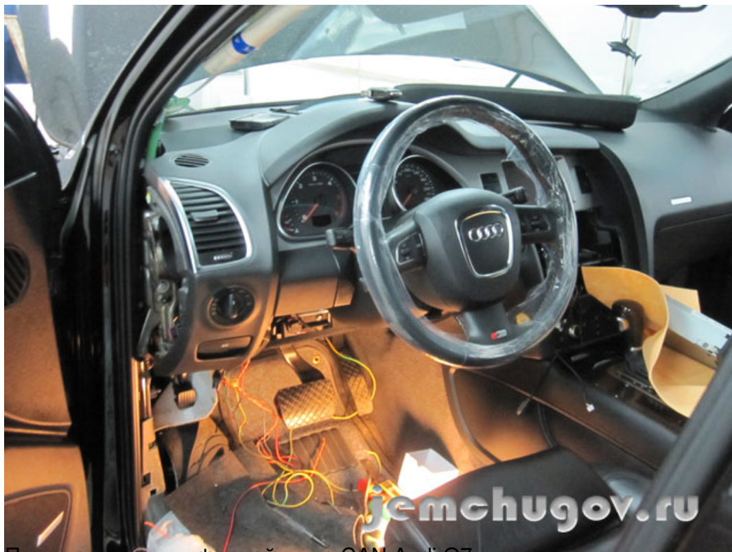
Подключение к цифровой шине CAN Audi Q7
