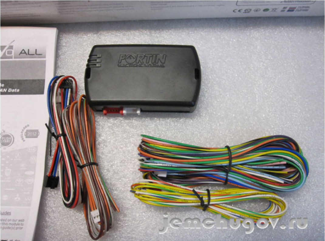
Подготовка жгутов сигнализации к установке
