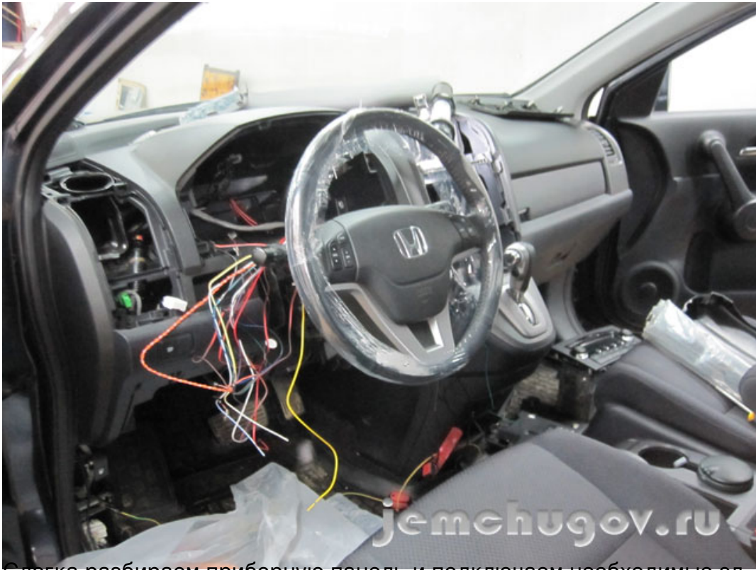
После разборки приборной панели и подключения необходимых элементов цепи
