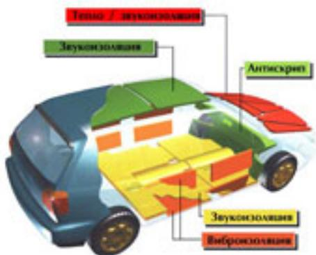
В дополнительной шумоизоляции, в первую очередь, нуждаются автомобили отечественного производства, затем средний класс корейских и японских автопроизводителей, либо в случаях, когда в автомобиль устанавливают дорогую качественную аудиосистему. По соотношению цена-качество лучшим вариантом являются шумоизоляционные материалы марки STP (Стандартпласт).
